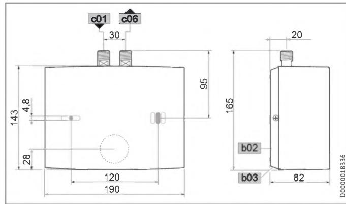
b02 Przepust na przewody elektr. I
